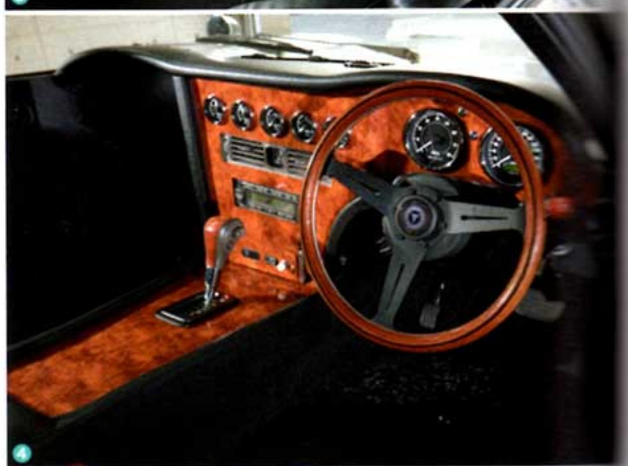
③内装は、木目パネルが美しい2000GTオリジナルの雰囲気を踏襲し、仕上げられている。④ATのシフトレバーも上手くインテリアに調和している。サイドブレーキの解除は、シフトパネルから生えるステッキで行う。これも2000GTの特徴的な装備をうまく再現したものだ。
