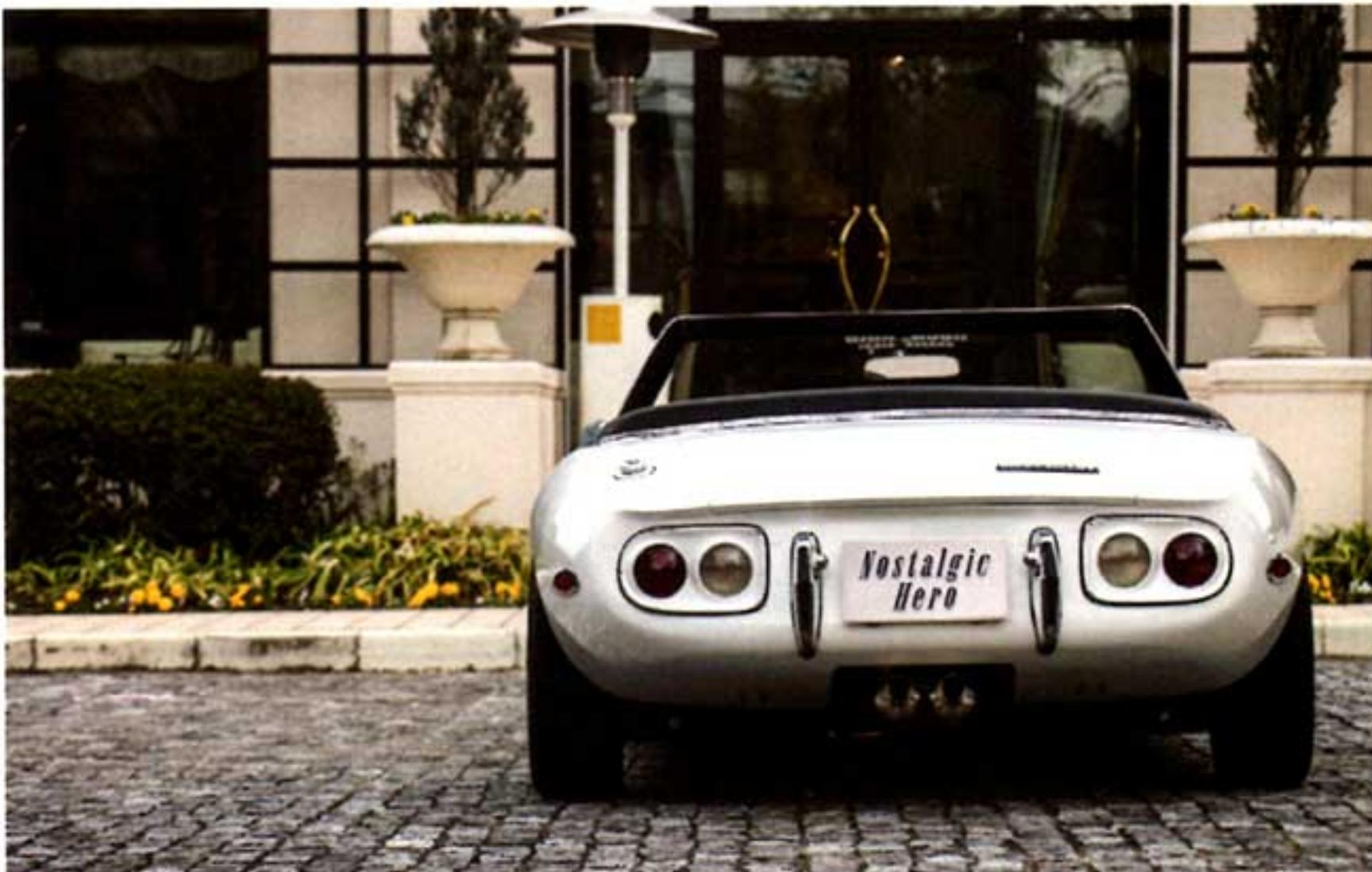
③キャラクターラインを生かすようにルーフからリアゲート部をカットし、官能的なフォルムを実現したボンドカー。スーパー・レプリカではそのボディラインを忠実に再現している。④センター2本出しのキャブトンマフラー。ガラスやエンブレムなど細かいパーツもすべて製作されたものだ。エンジンやミッションなどの機関系は、現代のモデルから流用しているため、トラブルフリーで乗れるのも魅力。⑤特徴的なリトラクタブルヘッドライトまわりも忠実に再現。
